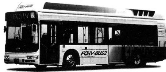
写真1 トヨタ・日野自動車が開発した燃料電池バス
