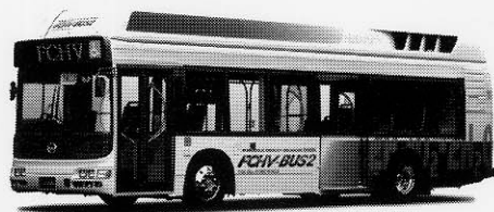
写真7 トヨタ・日野自動車が開発した燃料電池バス
